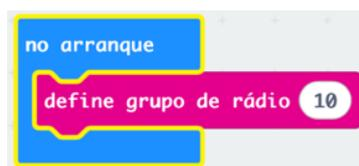
Figura 6: Bloco **no arranque** com a definição do valor da rádio
