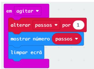
Figura 3: Conjunto de blocos no Bloco agitar
