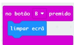
No bloco **no botão B premido** colocamos o bloco **limpar ecrã** que permite apagar os *led's* do *micro:bit*.
