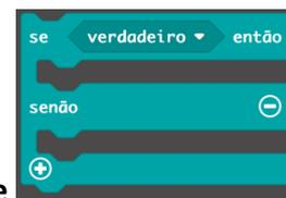
Debaixo do bloco **mostrar número**, temos que colocar um **bloco se**, que irá verificar o valor recebido **receivedNumber**, através de um **bloco de comparação**
