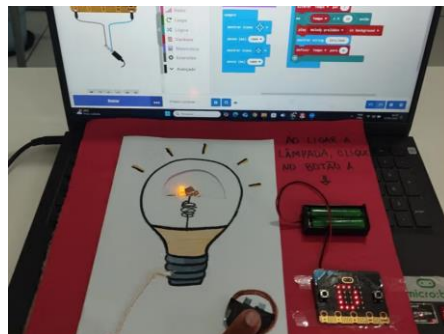
Figura 2: "Green Light Project" - solução simples com Micro:bit para alertar sobre consumo de energia. Fonte:
