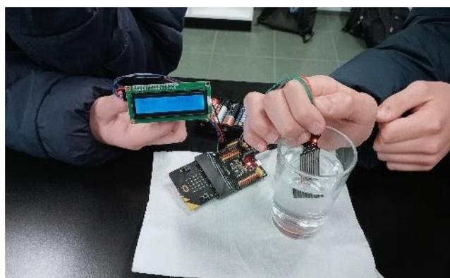
*Teste do sensor com copo de água e placa ligada, simulação do sistema de alerta para o nível da água*
