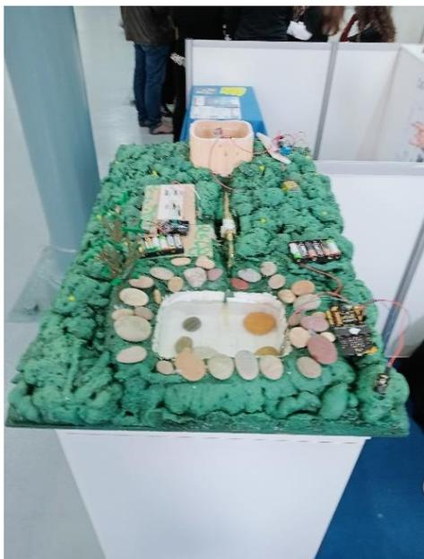
*Protótipo completo com micro:bit, Arduino, bomba e válvula integrados na maquete funcional*
