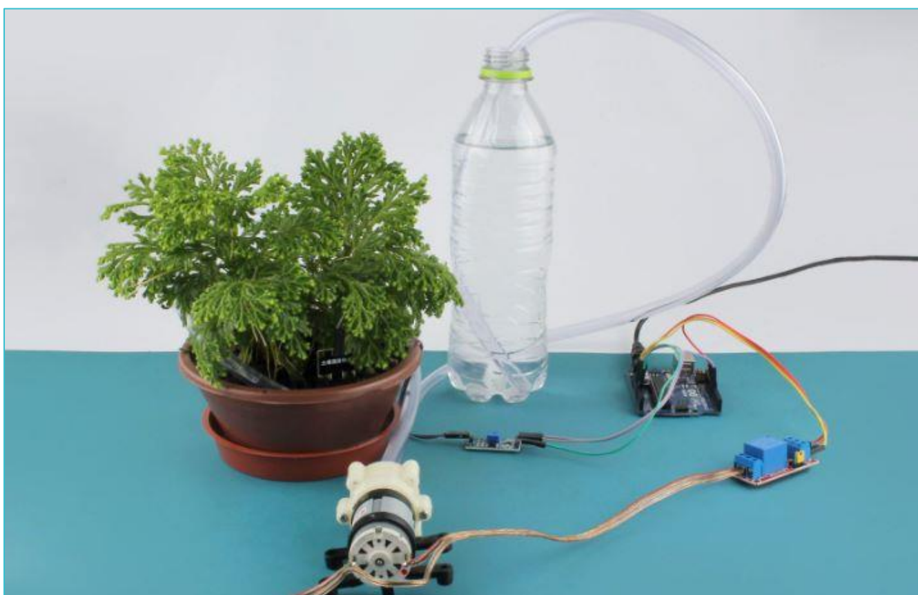
Figura 1: Instalação e teste de alguns dos componentes eletrónicos do projeto
